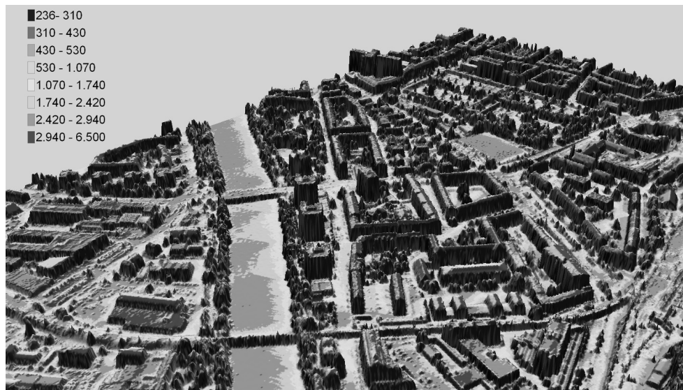
Abb. 3: Strahlungssumme (direkt und diffus) für einen Novembertag für Teile Innsbrucks in Wattstunden pro m^2 und Tag
